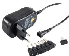
Universal Steckernetzgerät 3-12V, 600 mA, Netzspannung 230V, 50Hz, 22W, Polarität und Ausgangsspannung umschaltbar und stabilisiert, 6 x Adapterstecker, VDE und GS geprüft.
